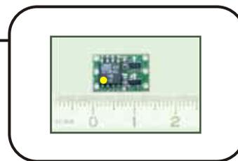
Die 2Kanalschalter bieten die Möglichkeit über einen Proportional Kanal zwei Schaltfunktionen zu steuern. Die abgebildeten 2Kanalschalter sind für BEC-Empfänger mit positivem Impuls geeignet.
